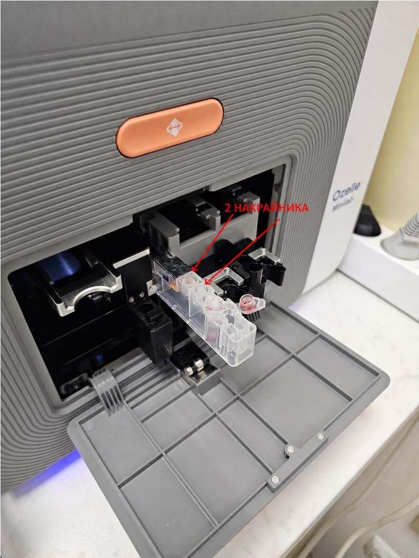
Фигура 8. Поставете два еднократни накрайника в означените гнезда на CBC комплекта.
